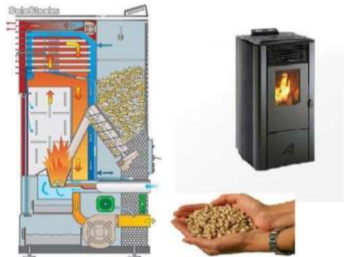
Estufa que funciona amb pel·lets de biomassa.
