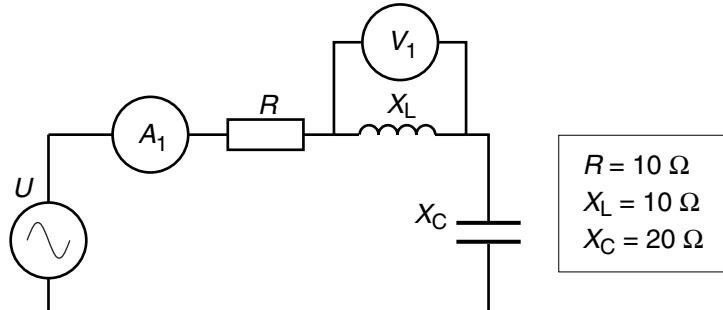
En el circuit de la figura, el valor de la tensió  $U$  comporta que la potència activa consumida sigui  $P = 250 \text{ W}$ . Determineu:
