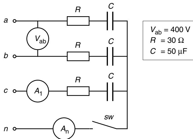
Per al circuit trifàsic de la figura, amb una freqüència d'alimentació de 50 Hz, determineu:
