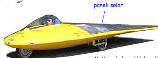
Moltes de les cèl·lules d'un cotxe solar estan connectades en sèrie.
