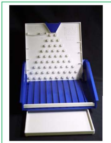
El dispositivo que aparece a la izquierda se denomina *aparato de Galton*. Su funcionamiento es el siguiente: cuando se introduce una bola por el embudo superior, va cayendo por los huecos que existen en cada fila. En cada paso puede caer por el hueco que tiene a su derecha o por el que tiene a su izquierda con igual probabilidad, de forma que es imposible, cuando ponemos una bola en el embudo predecir en cuál de los carriles inferiores acabará cayendo.
