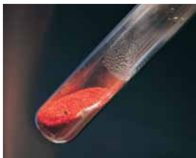
5. El tub d'assaig conté òxid de mercuri (II) de color ataronjat. En escalfar-lo, es descompon en mercuri i oxigen. És una reacció endotèrmica. Observa les petites gotes de mercuri que apareixen en les parets del tub d'assaig.
