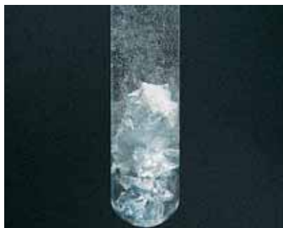
4. La reacció entre el zinc i l'àcid sulfúric desprèn energia en forma de calor. És una reacció exotèrmica. Si toquem les parets del tub d'assaig, podem comprovar que està calent.
