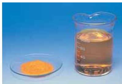
3. El permanganat de potassi \text{KMnO}_4 i el dicromat de potassi \text{K}_2\text{Cr}_2\text{O}_7 en solució aquosa, són molt usats al laboratori com a agents oxidants.
