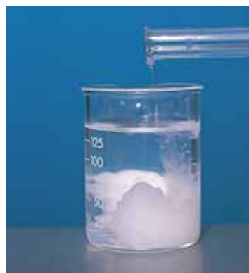
En afegir àcid sulfúric diluït a una solució d'hidròxid de bari, s'obté un precipitat blanc de sulfat de bari.
