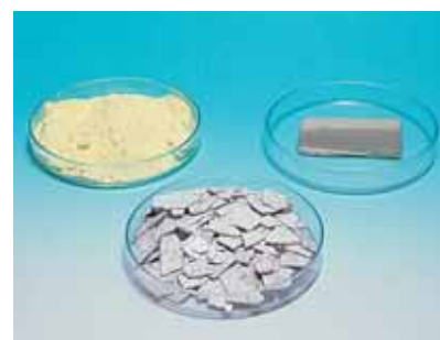
2. El sofre reacciona amb el sodi i s'obté sulfur de sodi. En aquesta reacció, el sofre guanya electrons, és l'oxidant, i el sodi els perd, és el reductor.
