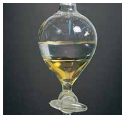
22. Separació de dos líquids immiscibles utilitzant un embut de decantació. Quan s'obre la clau, i es treu el tap superior, flueix primer el líquid més dens.
