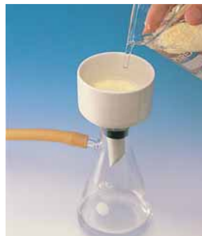
23. La filtració a pressió reduïda o filtració per succió requereix una trompa d'aigua i instrumental de vidre especial, però una vegada muntat és un sistema de filtració ràpid. L'embut utilitzat, de porcellana, s'anomena embut de Büchner i s'ajusta al matràs de Kitasato amb un tap de goma.
