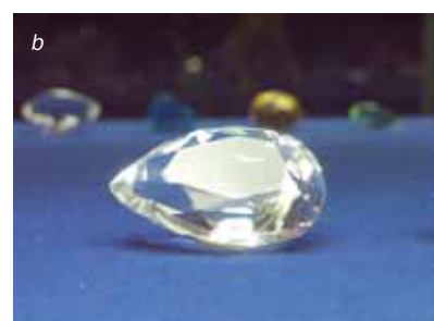
1. El grafit (a) i el diamant (b) tenen propietats molt diferents a causa exclusivament de la diferent disposició estructural dels àtoms de carboni.
