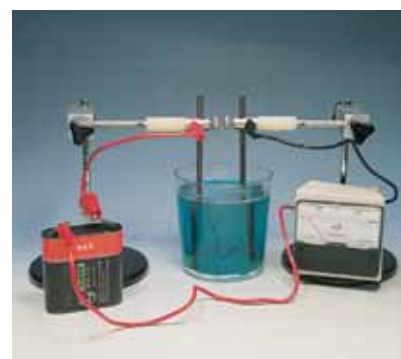
2. La cel·lula electrolítica conté una solució de clorur de coure (II). Quan circula el corrent es produeixen canvis químics a la superfície dels elèctrodes: es diposita coure a sobre del càtode (–) i es desprèn diclor a l'ànode (+).
