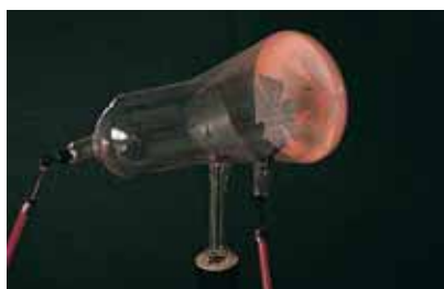
4. Quan col·loquem una creu en la trajectòria dels raigs catòdics, la seva ombra es projecta damunt de la paret del tub de vidre.
