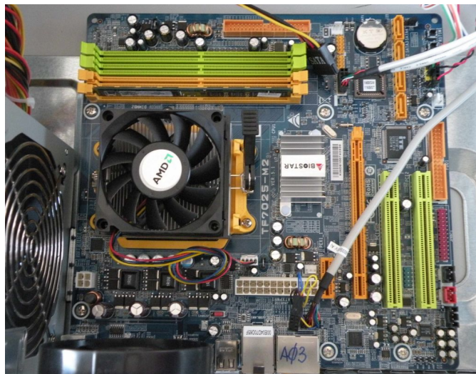
FIGURA 2.14. Placa base amb tot el connexionat de dades. Només falta connectar l'alimentació.
