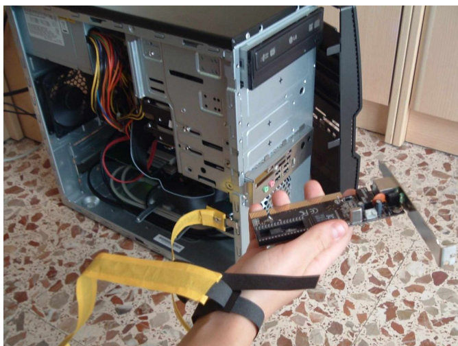
FIGURA 2.3. Utilització del braçalet antiestàtic
