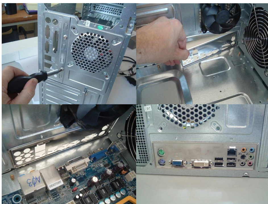
FIGURA 2.11. Col·loqueu l'embellidor per als connectors i encaixeu-hi la placa base.
