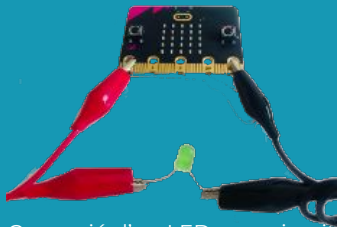
Connexió d'un LED a un circuit tancat entre el pin 0 i GND.
